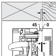
Tanda pemotongan  $0^\circ$  (8) menunjukkan posisi mata gergaji pada pemotongan persegi. Tanda pemotongan  $45^\circ$  (9) menunjukkan posisi mata gergaji pada pemotongan  $45^\circ$ . Untuk melakukan pemotongan yang tepat, dekati mesin gergaji bundar pada benda kerja seperti yang terlihat pada gambar. Sebaiknya lakukan uji coba pemotongan terlebih dulu.
