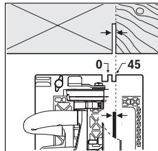
La marca de posición para  $0^\circ$  (9) muestra la posición de la hoja de sierra en caso de corte en ángulo recto. La marca de corte  $45^\circ$  (8) muestra la posición del disco de sierra en caso de corte de  $45^\circ$ .
