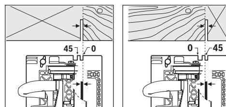
A marcação de corte de 0° (8) indica a posição da lâmina de serra num corte em ângulo reto. A marcação de corte de 45° (9) indica a posição do disco de serra num corte num ângulo de 45°.
