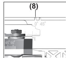
Use a marcação de corte (8) num corte em ângulo reto e num corte de 45° com calha de guia.
