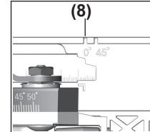
Utilize apenas marcação de corte (8) no corte em ângulo reto e no corte em 45° com calha de guia.
