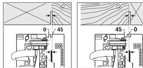
เครื่องหมายตัด 0° (9) แสดงตำแหน่งของใบเลื่อยสำหรับการตัด เครื่องหมายตัด 45° (8) แสดงตำแหน่งของใบเลื่อยสำหรับการตัดล่วงหน้า
