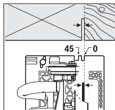
La marca de posición para  $0^\circ$  (8) muestra la posición de la hoja de sierra en caso de corte en ángulo recto. La marca de corte  $45^\circ$  (9) muestra la posición del disco de sierra en caso de corte de  $45^\circ$ .
