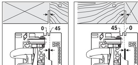
A marcação de corte de 0° (9) indica a posição da lâmina de serra num corte em ângulo reto. A marcação de corte de 45° (8) indica a posição do disco de serra num corte num ângulo de 45°.
