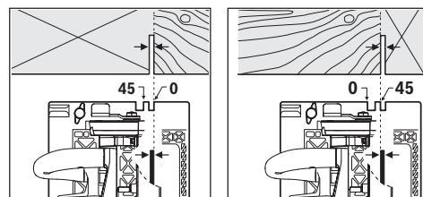
A marcação de corte 0° (8) indica a posição do disco de serra no corte em ângulo reto. A marcação de corte 45° (9) indica a posição do disco de serra no corte em 45°.
