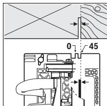
Dấu cắt  $0^\circ$  (9) hiển thị vị trí của lưỡi cưa ở vết cắt vuông góc. Dấu cắt  $45^\circ$  (8) hiển thị vị trí của lưỡi cưa ở vết cắt  $45^\circ$ .
