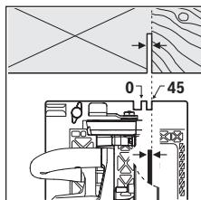
Tanda pemotongan  $0^\circ$  (9) menunjukkan posisi mata gergaji pada pemotongan persegi. Tanda pemotongan  $45^\circ$  (8) menunjukkan posisi mata gergaji pada pemotongan  $45^\circ$ . Untuk melakukan pemotongan yang tepat, dekati mesin gergaji bundar pada benda kerja seperti yang terlihat pada gambar. Sebaiknya lakukan uji coba pemotongan terlebih dulu.
