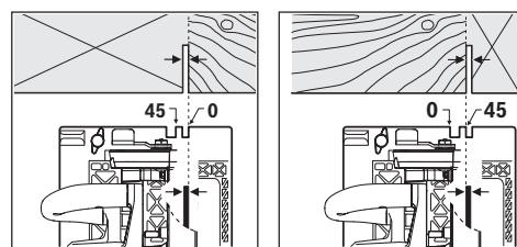
เครื่องหมายตัด 0° (8) แสดงตำแหน่งของใบเลื่อยสำหรับการตัดเป็นมุมจาก เครื่องหมายตัด 45° (9) แสดงตำแหน่งของใบเลื่อยสำหรับการตัด 45°
