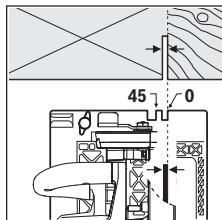
Dấu cắt  $0^\circ$  (8) hiển thị vị trí của lưỡi cưa ở vết cắt vuông góc. Dấu cắt  $45^\circ$  (9) hiển thị vị trí của lưỡi cưa ở vết cắt  $45^\circ$ .
