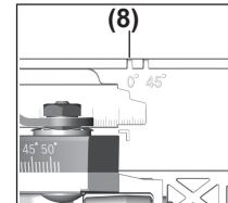
Cukup gunakan tanda pemotongan (8) saat memotong bentuk persegipanjang dan siku-siku  $45^\circ$  dengan rel pemandu.
